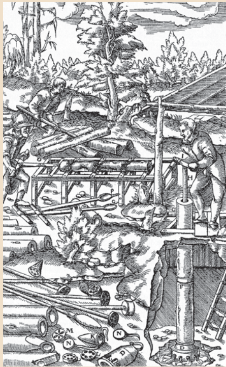
Abb. 18: Herstellung, Komponenten und Betrieb einer Saughub-Pumpe (aus AGRICOLA 1556)
